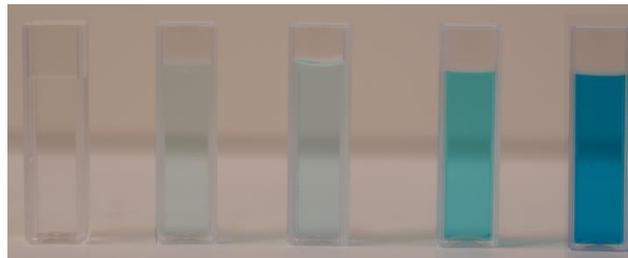
Küvetten mit Farbstofflösung, von links nach rechts: Wasser, Sportgetränk-Lösung, Farbstofflösungen (5 mg/L, 10 mg/L, 20 mg/L) (Foto: Akram)
