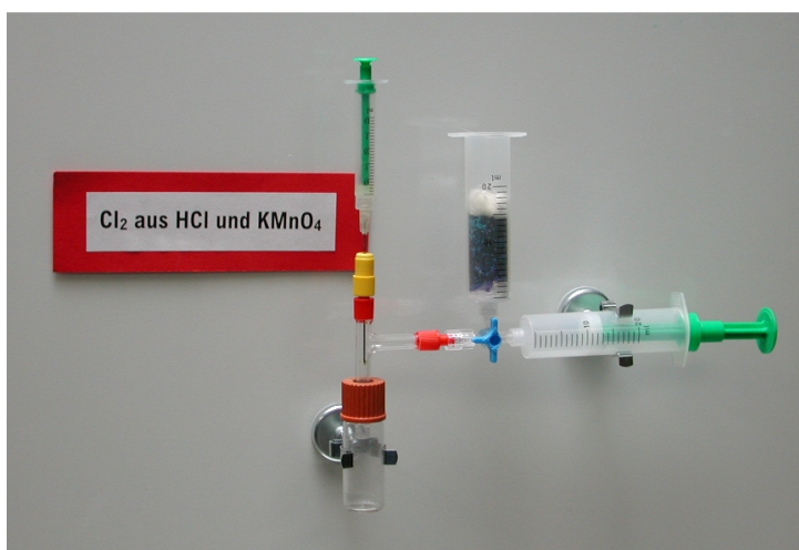
Absorptionsröhrchen in einer Chlorapparatur
