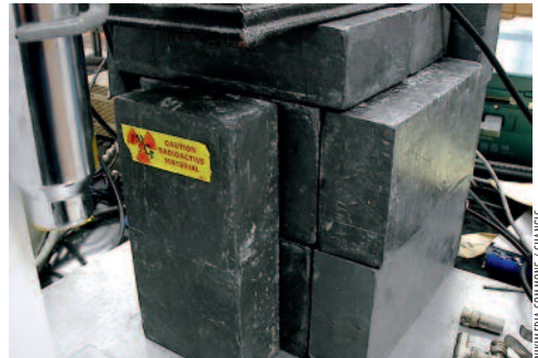
Bleimantelung zum Schutz vor radioaktiver Strahlung
