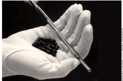
Brennstab mit Pellets
